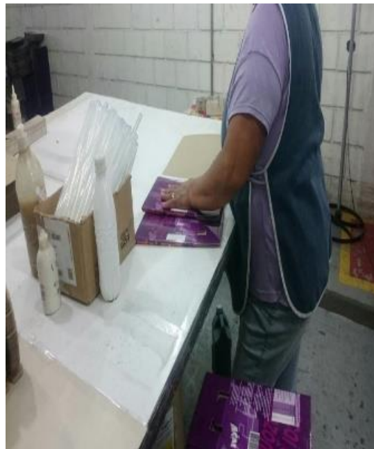
Figura 4: Operária utilizando cola quente para unir a caixa externa já com a caixa antivazamentos dentro da mesma (GRUPO IG, 2015)
