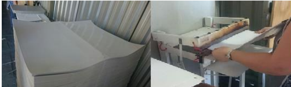
Figura 2: Selagem das caixas internas (Grupo IG, 2015)
