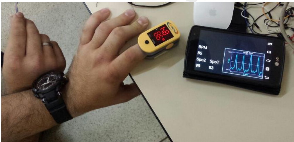
Figura 7: Teste usando o equipamento desenvolvido e o oxímetro comercial
