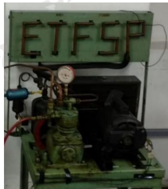
Figura 2: Compressor, Condensador e Motor do Sistema de Refrigeração Fonte: Autores
