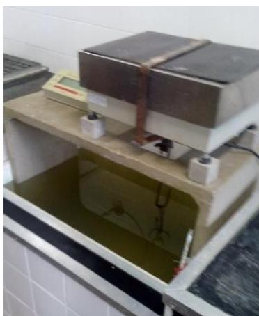
Figura 2 – Balança hidrostática
