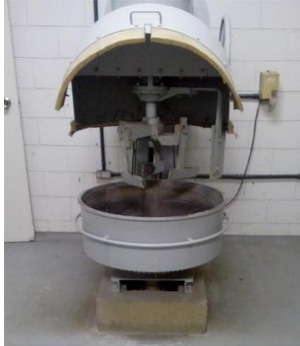
Figura 3 – Betoneira de eixo planetário e equipamento
