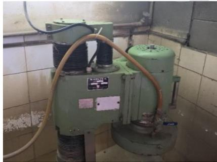
Figura 4 – Retificadora de topo de corpo de prova
