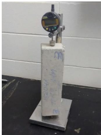
Figura 5 – Equipamento para ensaio de retração do concreto
