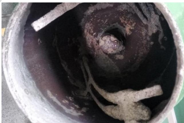
Figura 8 - Betoneira do IFSP com material aderido no tambor
