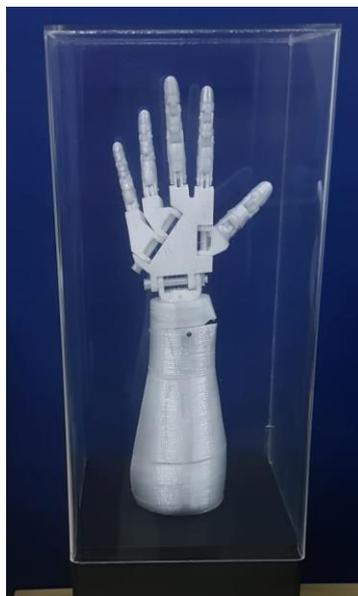
Figura 12: Braço eletromecânico sob domo de acrílico com eletrônica embarcada
