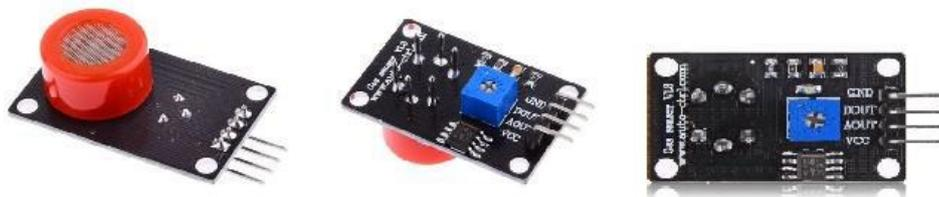
Figura 1: Módulo do sensor MQ-3
