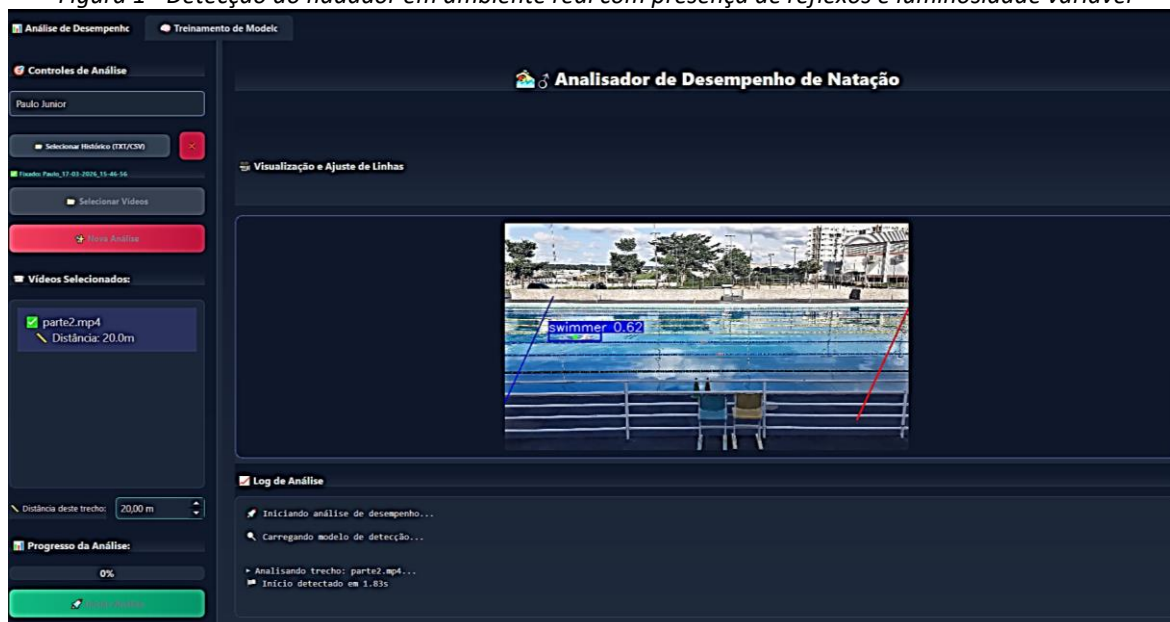
Figura 1 - Detecção do nadador em ambiente real com presença de reflexos e luminosidade variável
