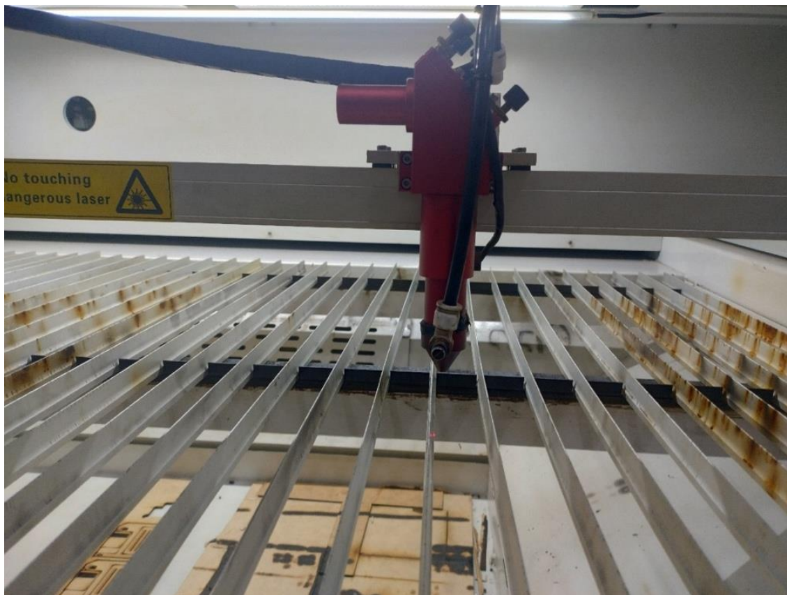
Figura 3 – Emissor de um feixe de laser cortante, instalado no interior da máquina CNC
