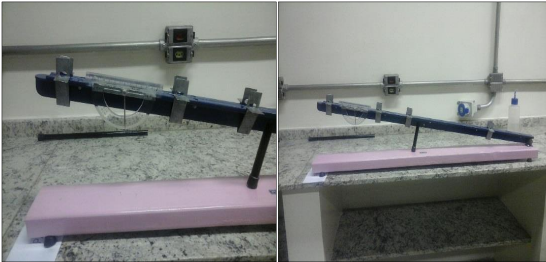
Figura 6 – Imagens com o apoio para a obtenção da inclinação e o transferidor para medida do ângulo de inclinação.
