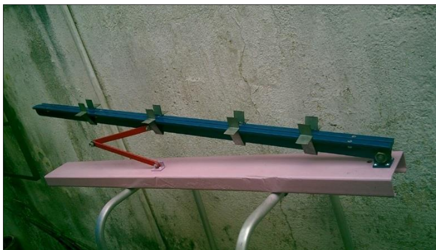
Figura 5 – Estrutura do plano inclinado com o braço articulado para elevação, utilizado inicialmente, e presilhas para fixação dos sensores. A perfuração da chapa de aço foi efetuada com furadeira.
