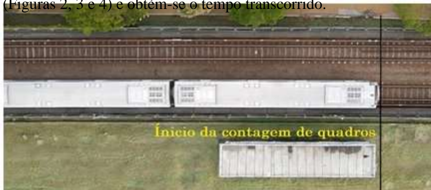
Figura 2 – Início da contagem dos quadros. A linha vertical, em destaque, foi introduzida na figura como referência para medida da distância percorrida pelo trem.
