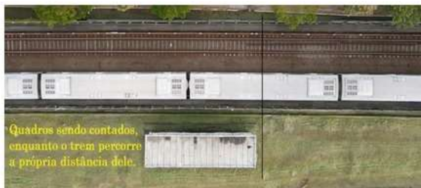
Figura 3 – Movimentação do trem no trecho de aceleração. Conhecendo-se o comprimento do trem, que é de 130,5 metros, é possível obter a distância percorrida pelo trem em cada quadro. A partir destas informações um gráfico da distância percorrida versus tempo foi construído.
